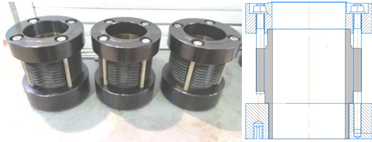
Рисунок 1 –Фото и эскиз цилиндра в картридже
