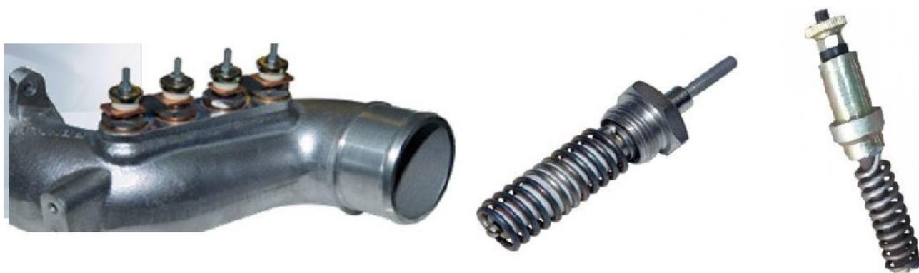
Рисунок 1.4– Впускной трубопровод двигателя ЯМЗ 650.10
