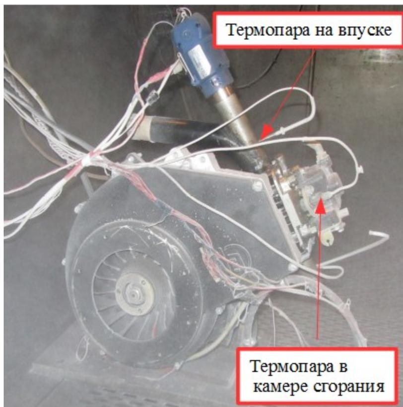
Рисунок 4.1 – Фото дизеля с нагнетателем теплого воздуха на впуске
