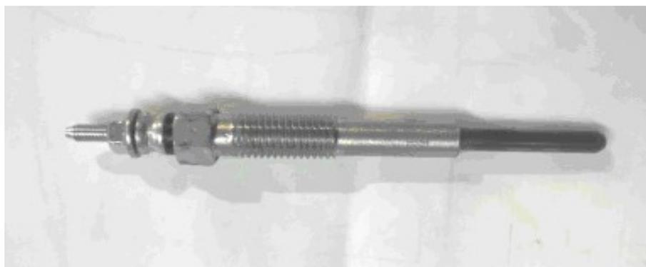
Рисунок П.3 – Штифтовая свеча камеры сгорания
