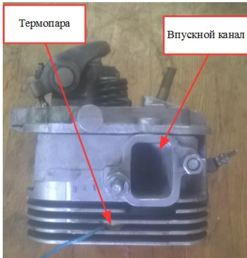
Рисунок 4.3 – Расположение термопары на ребре головки цилиндра
