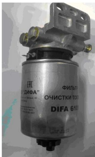
Рисунок П.2 – Фильтр - подогреватель топлива
