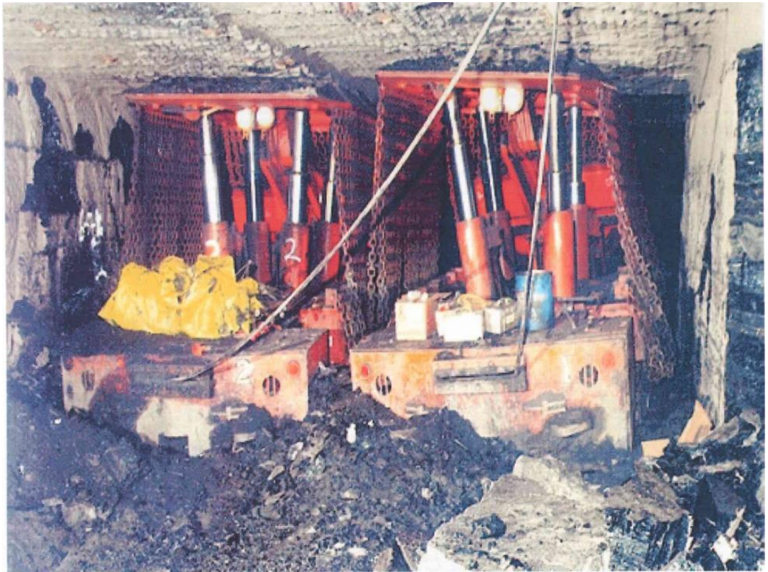
Рисунок 2.18 – Мобильные (самоходные) механизированные крепи (MRS)
