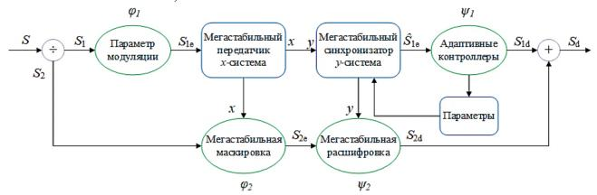
Рис. 11. Хаотическая мегастабильная схема безопасной связи
