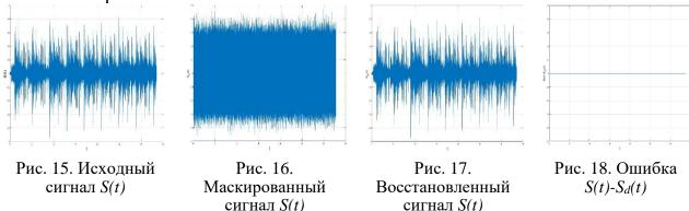
Собрав оба вектора  $S_{1d}$  и  $S_{2d}$ , мы получим весь восстановленный информационный сигнал  $S_d$ . Приемник может преобразовать этот вектор чисел обратно в текст, используя инструмент MATLAB "char". Восстановленное сообщение показано на рис. 17. Ошибка S(t)- $S_d(t)$  между переданным звуковым сигналом и восстановленным сигналом показана на рис. 18, как видно, исходный волновой сигнал точно восстановлен.
