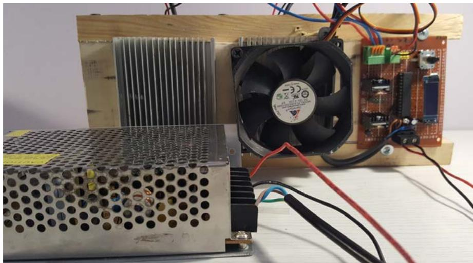
Рис. 4.9. Прототип устройства тестирования разрешения тепловизионных систем по контрасту
