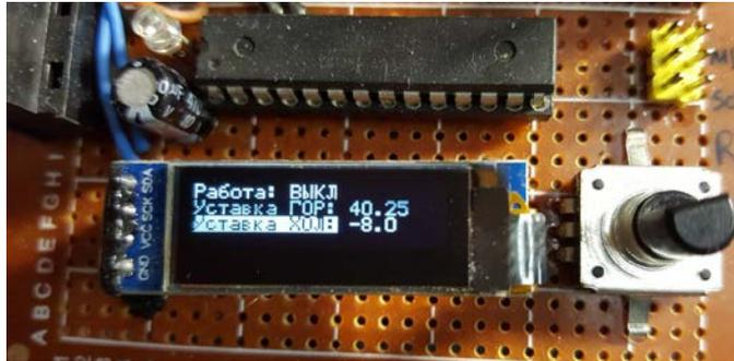
Рис. 4.11. Отображение установленных температур
