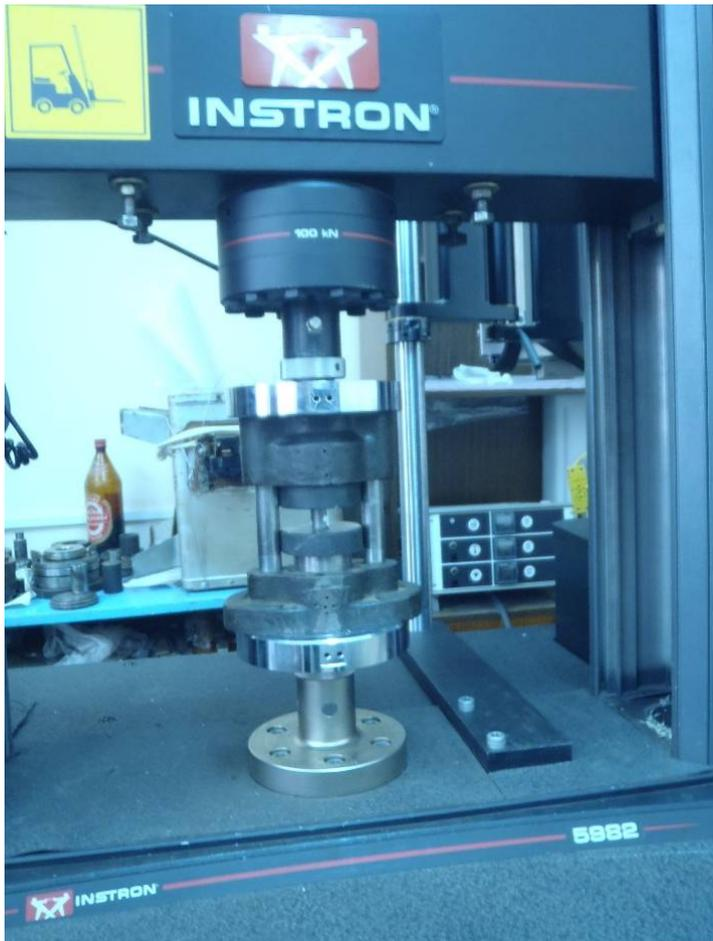
Оборудование для испытания чугуна тубингов
