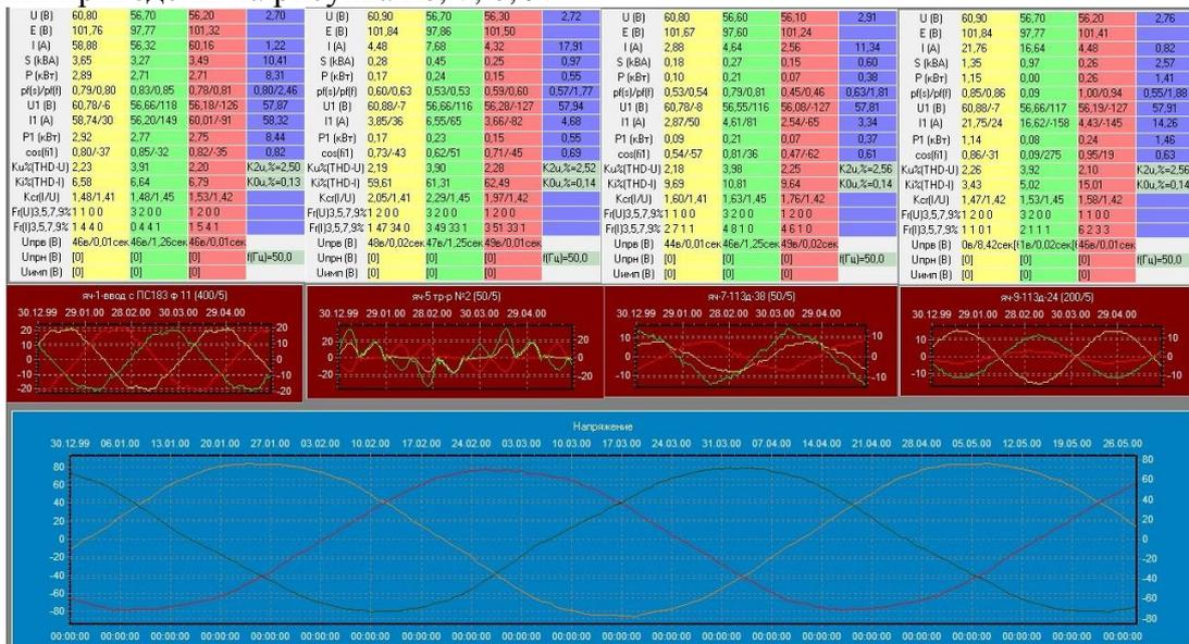
Рис. 6. Показатели качества электроэнергии, формы токов и напряжений ТП-113 (Алексин); красный фон – кривые токов; голубой фон – кривые напряжений
