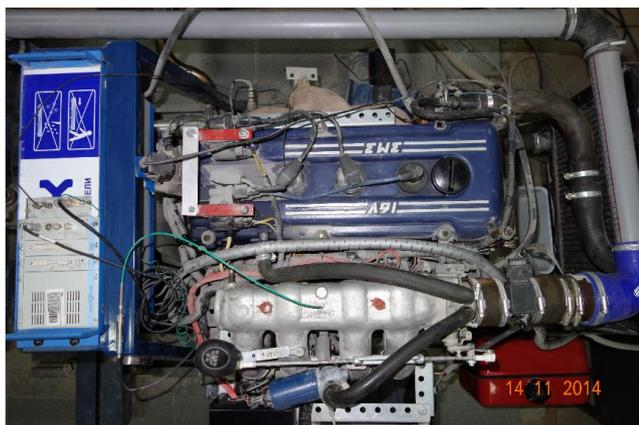
Рис. 2. Экспериментальная установка двигателя ЗМЗ 4062 с комплектом измерительного экспериментального оборудования фирмы "Kistler"
