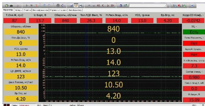
Рис. 3. Общий вид интерфейса программного комплекса DiSco Motor-Scan
