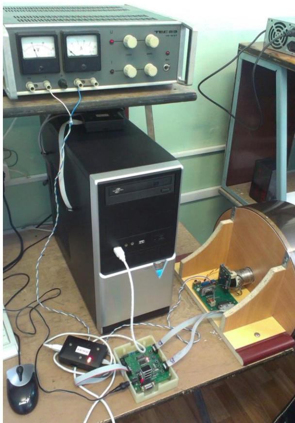
Рис. 3.3. Лабораторный стенд Мотор-маятник
