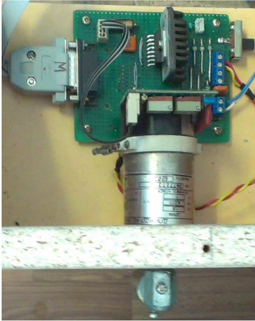
Рис. 3.4. Плата управления и двигатель ММ
