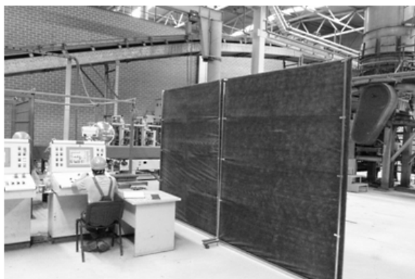
Рис. 4. Конструктивное исполнение блока защитных экранов, изготовленных из звукопоглощающих матов, и схема расположения на участке формования (рабочее место № 3)
