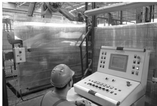
Рис. 3. Конструкция системы звукоотражающих экранов, рассчитанная методом суперпозиции и изготовленная из сотового поликарбоната, на рабочем месте оператора участка разгрузки (рабочее место № 6)
