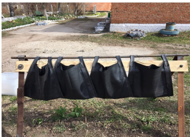
Рис. 1. Экспериментальная установка с использованием метода геотубирования
