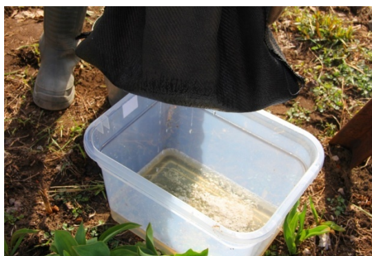
Рис. 2 Процесс обезвоживания осадка методом геотубирования с использованием флокулянта «Гринлайф»
