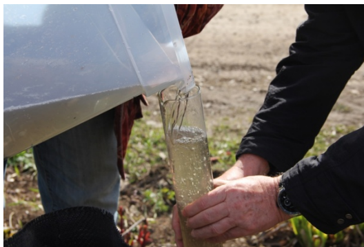
Рис. 3. Измерение объёма фильтрата мерным цилиндром
