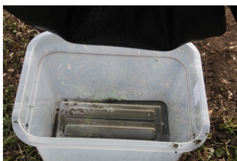
Рис. 4 Процесс обезвоживания осадка методом геотубирования без использования флокулянта
