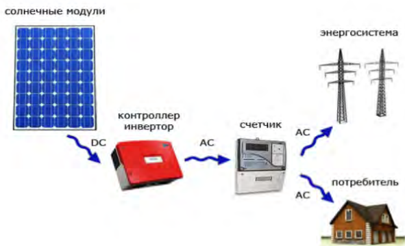
Рис. 3 – Структура солнечной электростанции, соединенной с сетью
