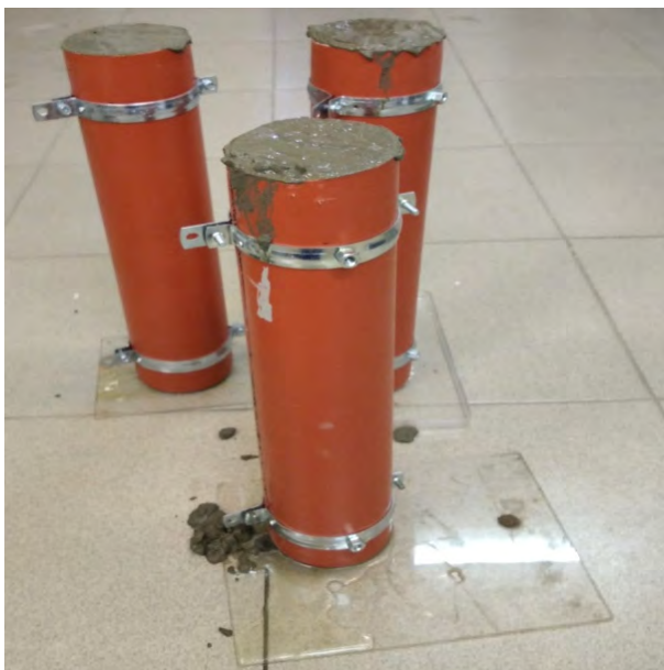
Рис. 1 Заполнение бетонной смеси в специальные формы
