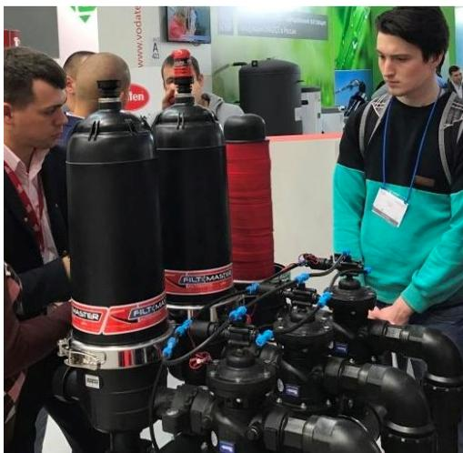
Рис. 2. Пример современной установки механической очистки сетевой воды от твердых примесей
