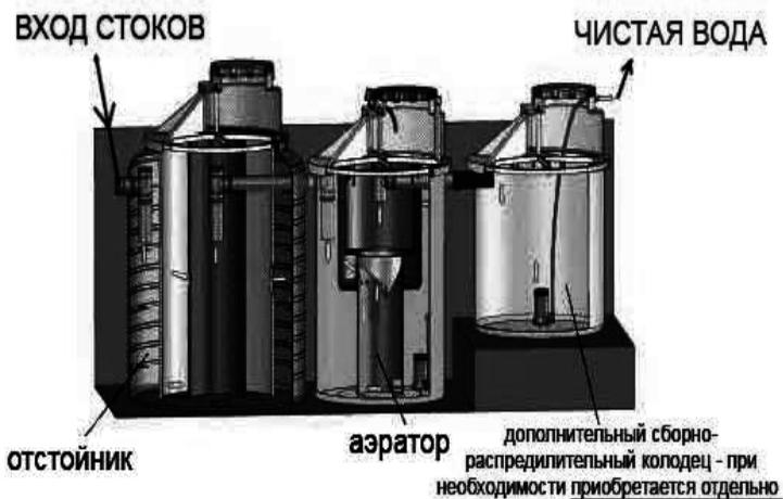
Рис. 1. Станция глубокой биологической очистки сточных вод
