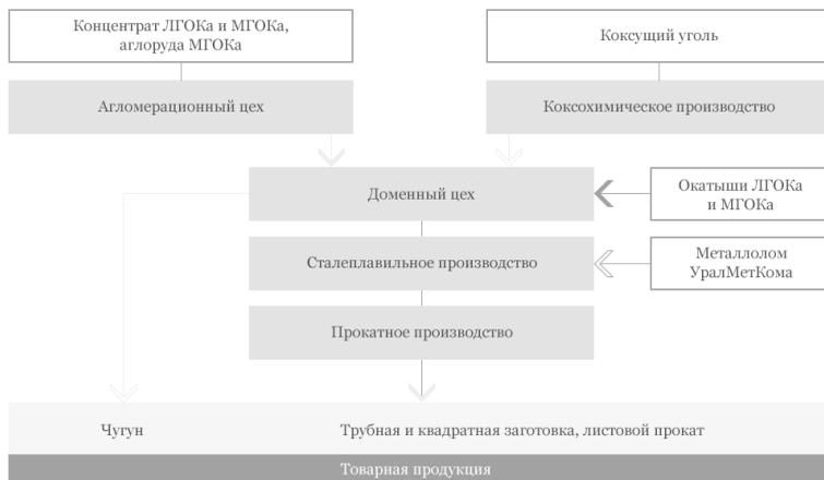
Рисунок 1 – Технологические процессы «Уральской Стали»
