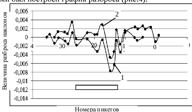
Рис.4 Отклонения измеренных наклонов земной поверхности от рассчитанных
