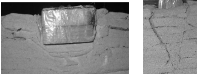
Рис. 1. Разрез модели перпендикулярно (а) и параллельно (б) оси выработки
