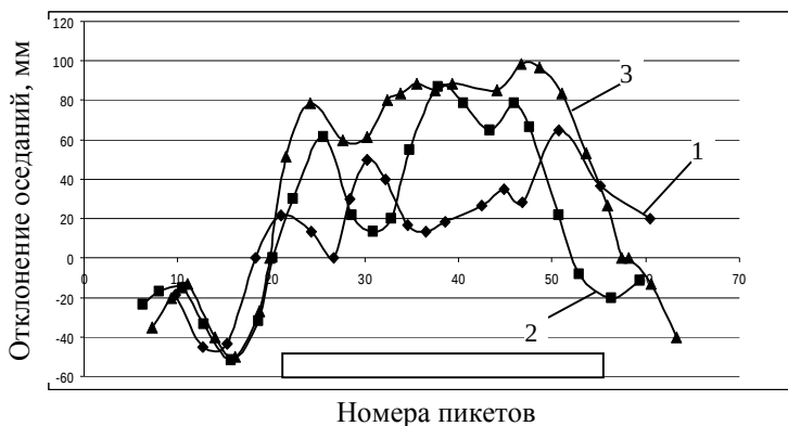
Рис. 2 - Распределение отклонений оседаний земной поверхности между измеренными и рассчитанными данными
