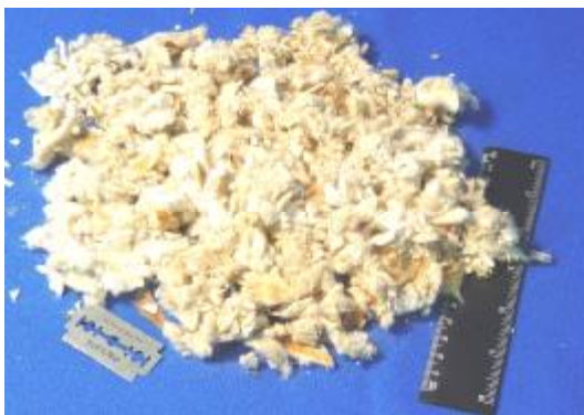
Рис. 1. Материал с развитой активной поверхностью, получаемый при механической переработке техногенного сырья производства линолеума ПВХ
