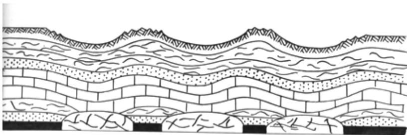
Рис. 1. Характер деформаций земной поверхности при оставлении целиков
