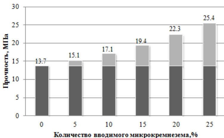
Рис. 1. Зависимость прочности бетона от содержания микрокремнезема
