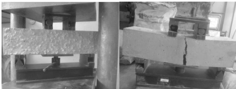
Рис. 3. Определение предела прочности при растяжении путем испытания образцов-призм на изгиб
