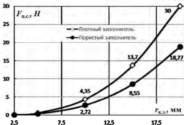
Рис. 2. Изменение центробежной силы ( $F_{ц.с.}$ ) в зависимости от радиуса крупного заполнителя ( $r_{к.з.}$ )
