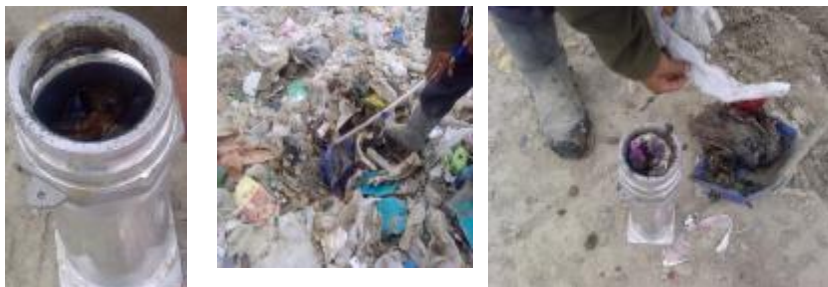
Рис. 1. Реактор для исследования биodeградации модельной пробы ТБО. Отбор проб с полигона (месячного «возраста»)
