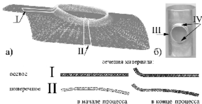
Рис. 1. Принципиальная схема формоизменения в конечно-элементной модели [4], построенной с использованием программного комплекса Elmaform 4.2: а - расчетная трехмерная модель МКЭ; б – деформированная цилиндрическая заготовка; I, IV – осевое; II, III – поперечное сечения
